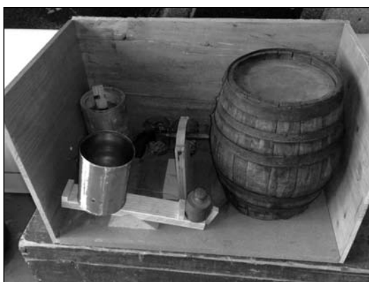
Nella foto il modello in scala 1:3 del possibile ordigno che affondò il Piroscalo "Ercole"
